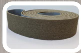
**AB-HP Vliesschleifband** ist ein Vliesband mit breitem Körnungsspektrum für das Finish von Edelstahloberflächen im Flächenschliff und überzeugt mit einem feinen Schlibfbild. Das offen strukturierte Vlies, kaschiert auf einen stabilen X-Gewebetträger, ist ideal für die Edelstahlbearbeitung auf Langbandmaschinen geeignet. Es ist in den Feinheitsgraden A-med, A-Fine, A-very fine, HS A-very fine lieferbar.
